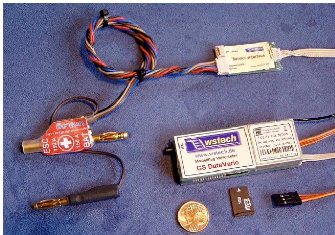
CS DataVario mit Sensor-Interface u. Stromsensor
