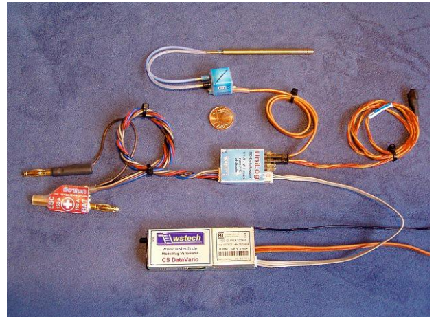
hier mit UniLog u. Strom-, Speed- u. Temp.-Sensor
