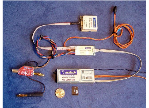
Mit Sensor-Interface, GPS, Strom- u. Temp.-Sensor
