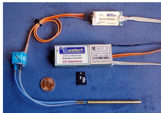
CS DataVario mit Sensor-Interface u. Speed-Sensor
