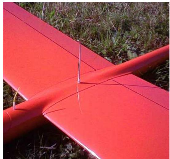
Das LinkVario bietet die Möglichkeit eine TEK-Düse (Total Energie Kompensation) anzuschließen, eine Technik, die von der Großfliegerei übernommen wurde. Die Düse wird im Normalfall am Seitenleitwerk angebracht und mit einem Schlauch mit dem entsprechenden Anschluss an der **BU** verbunden. Es ist auch, wie im rechten Bild abgebildet, eine Sonderform für V-Leitwerke erhältlich, sie wird auf dem Rumpf über bzw. knapp hinter den Tragflächen angeordnet.
