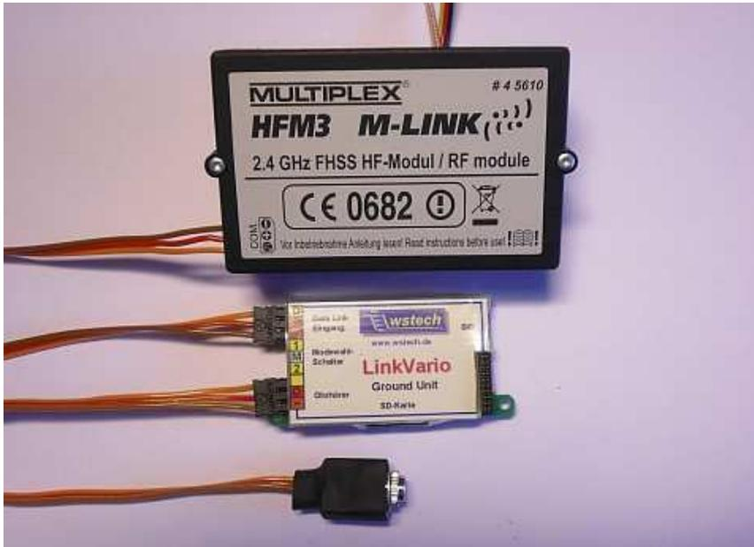
Das Ohrhörer-Adapterkabel wird mit dem Ausgang **Ohrhörer** der GU verbunden.
