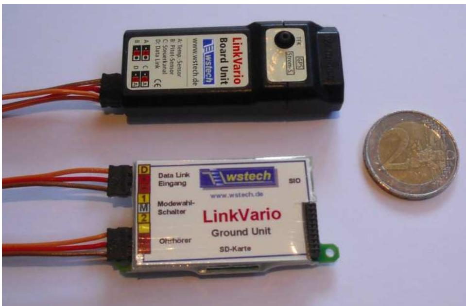
LinkVario Board und Ground Unit Universal zur Integration in Multiplex MC4000/3030-Sender
