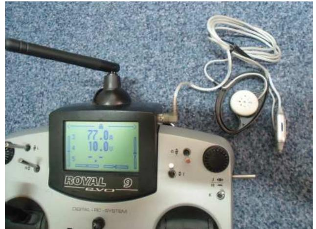
Rechts: Ohrhörer mit Lautstärkereglern in der Verbindungsleitung an der neu hinzugefügten Klinkenbuchse.
