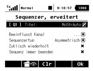
Der Sequenzer hat mit der Einstellung **Sequenzertyp Asymmetrische** die Eigenschaft beim Ein- **und** Ausschalten des Motor-Ein-Schalters L3 den Ablauf abzuspulen. Um hier eine erneute Ansage bei Motor-Aus zu unterdrücken, werden die Sequenzerausgänge Q1 u. Q2 jeweils mit den Motor-Ein-Schalter verknüpft.
