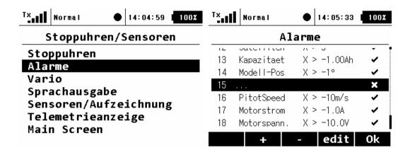
Damit nun solch ein Alarm für die Ansage des jeweiligen Werts herangezogen werden kann, muss die Alarmschwellen so eingestellt werden, dass diese immer erfüllt ist.
