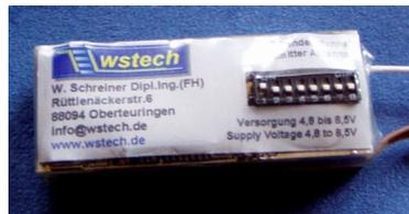
Als Empfänger für den Piloten können alle 69-Kanal LPD Handfunkgeräte (ISM-Band 433MHz) verwendet werden, nicht zu verwechseln mit PMR-Geräten bei 448MHz. Das von wstech gelieferte Empfangsgerät ist ein LPD/PMR-Kombigerät und ermöglicht die Nutzung beider Frequenzbänder. Mit einem Scanner oder ähnlichen Handgerät (70cm- Amateurfunk) lassen sich auch die 139-Kanäle im 12,5Khz-Raster nutzen.
