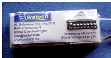
Als Empfänger für den Piloten können alle 69-Kanal LPD Handfunkgeräte (ISM-Band 433MHz) verwendet werden, nicht zu verwechseln mit PMR-Geräten bei 448MHz. Das von wstech gelieferte Empfangsgerät ist ein LPD/PMR-Kombigerät und ermöglicht die Nutzung beider Frequenzbänder. Mit einem Scanner oder ähnlichem Handgerät (70cm- Amateurfunk) lassen sich auch die 139-Kanäle im 12,5Khz-Raster nutzen.
