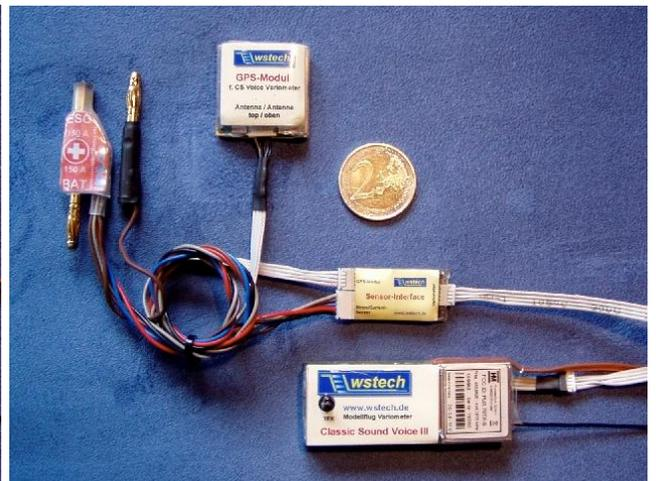
CS Voice III mit Sensor-Interface, GPS u. Stromsensor
