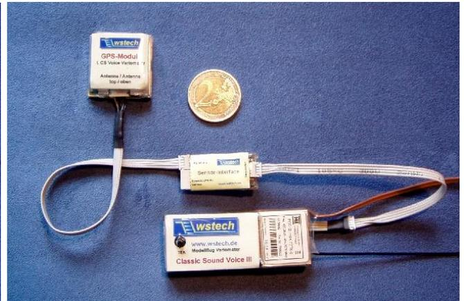
CS Voice III mit Sensor-Interface u. GPS-Modul
